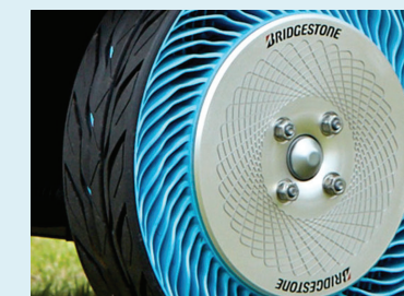
브리지스톤의 비공기압 타이어 기술 "에어 프리 컨셉트" 고유의 스포크 구조를 사용하여 하중을 지지하는 비공기압 타이어(NPT)
